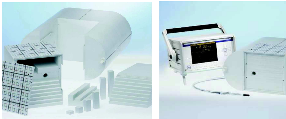
Fig 3.5 Esquerra, maniquí Scanditronix l'mRT amb els diferents accessoris. Dreta conjunt electròmetre més cambra d'ionització utilitzats per mesurar la dosi absoluta en tècniques d'IMRT. Figures obtingudes de la pàgina web de Scanditronix, www.scanditronix.com .
