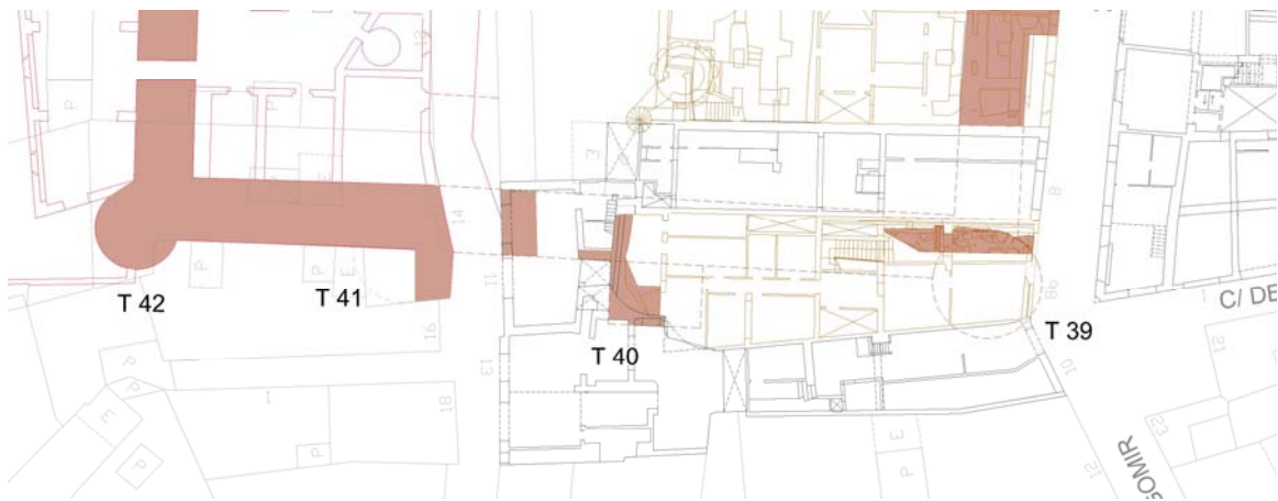
Figura 101. Finca c/ Ataülf nº 13 Identificació de les restes i restitució de la planta del perímetre quadrangular de la torre nº 40.
