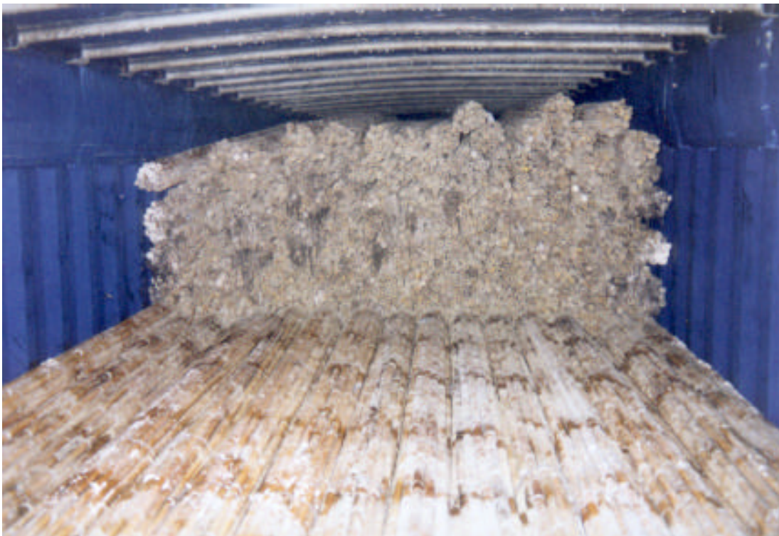
Fotografía nº 30. Fuerte condensación en un transporte de caña de bambú en un contenedor open top de 40'
