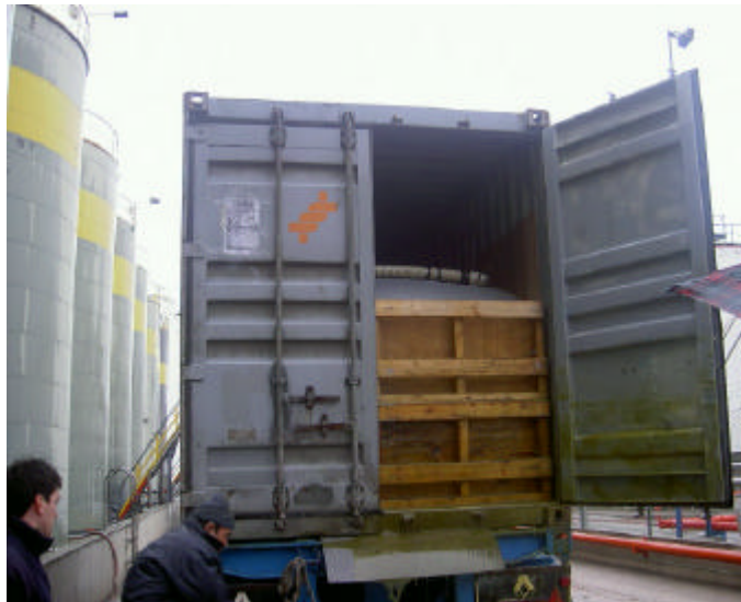
Fotografía nº 9. Contenedor con flexi-tank
