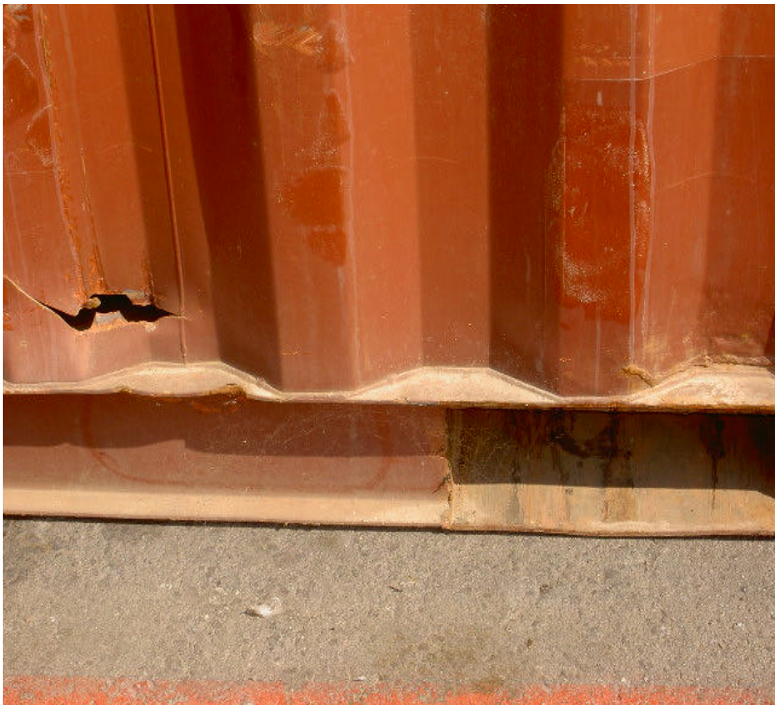
Fotografía nº 22. Impacto de pala con rotura de la plancha en el panel lateral de un contenedor dry box de 20'
