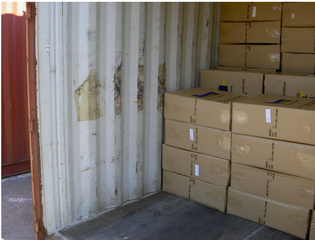
Fotografía nº 35. Corrugas interiores de un contenedor dry box
