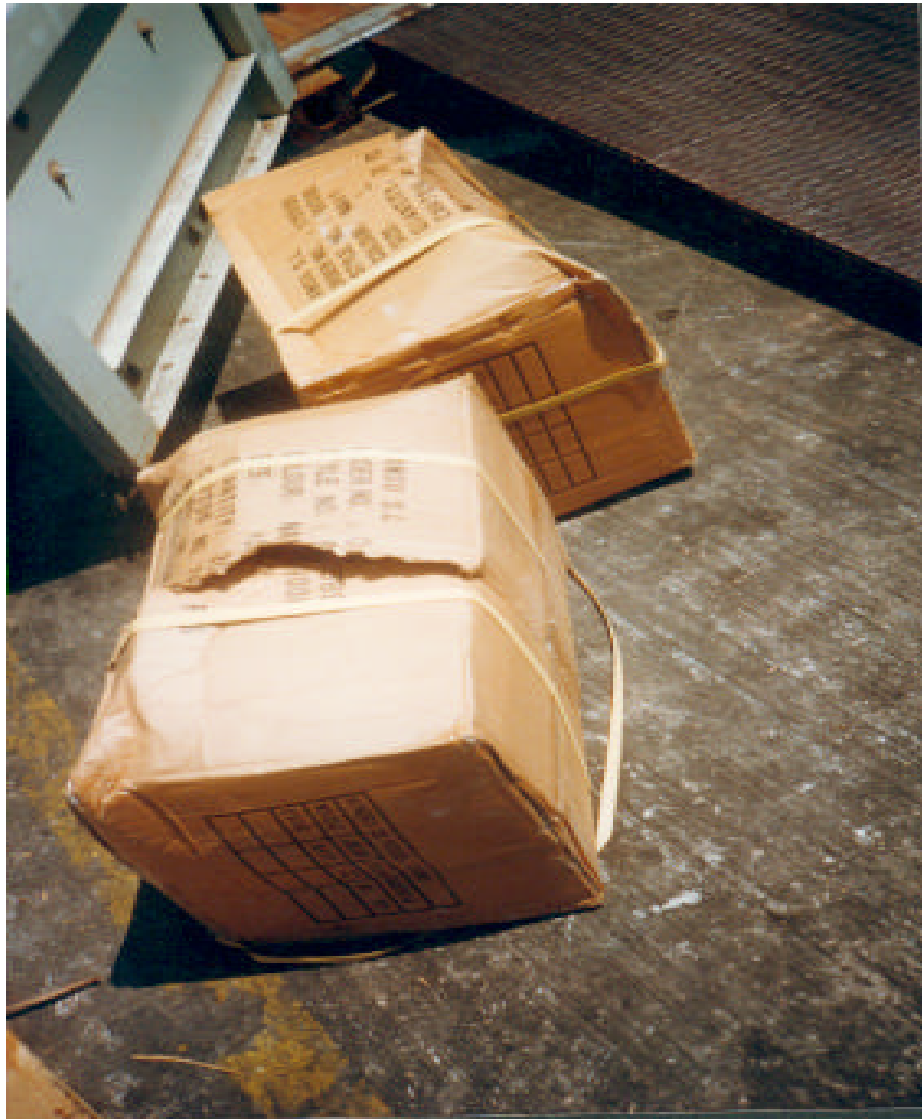
Fotografía nº 26. Cajas aplastadas por incorrecta estiba dentro del contenedor
