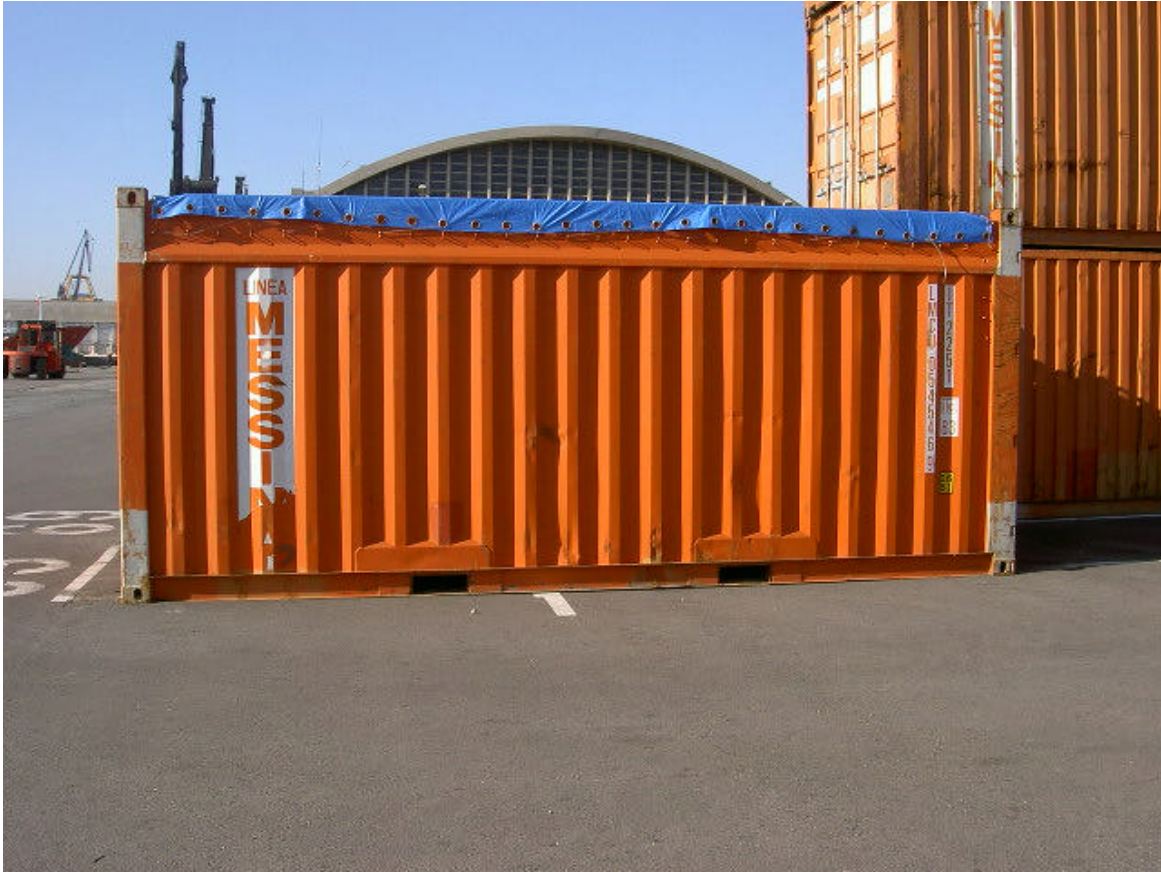
Fotografía nº 4. Contenedor open top de 20'
