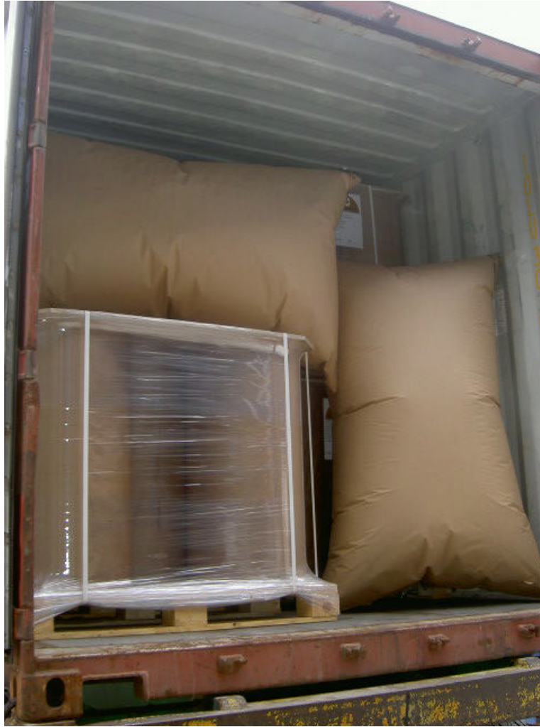
Fotografía nº 32.Palets asegurados con air bags
