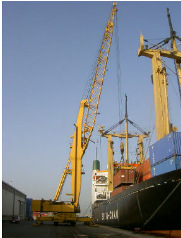
Fotografía nº 21. Grúa Auto-Móvil trabajando un buque portacontenedores convencional
