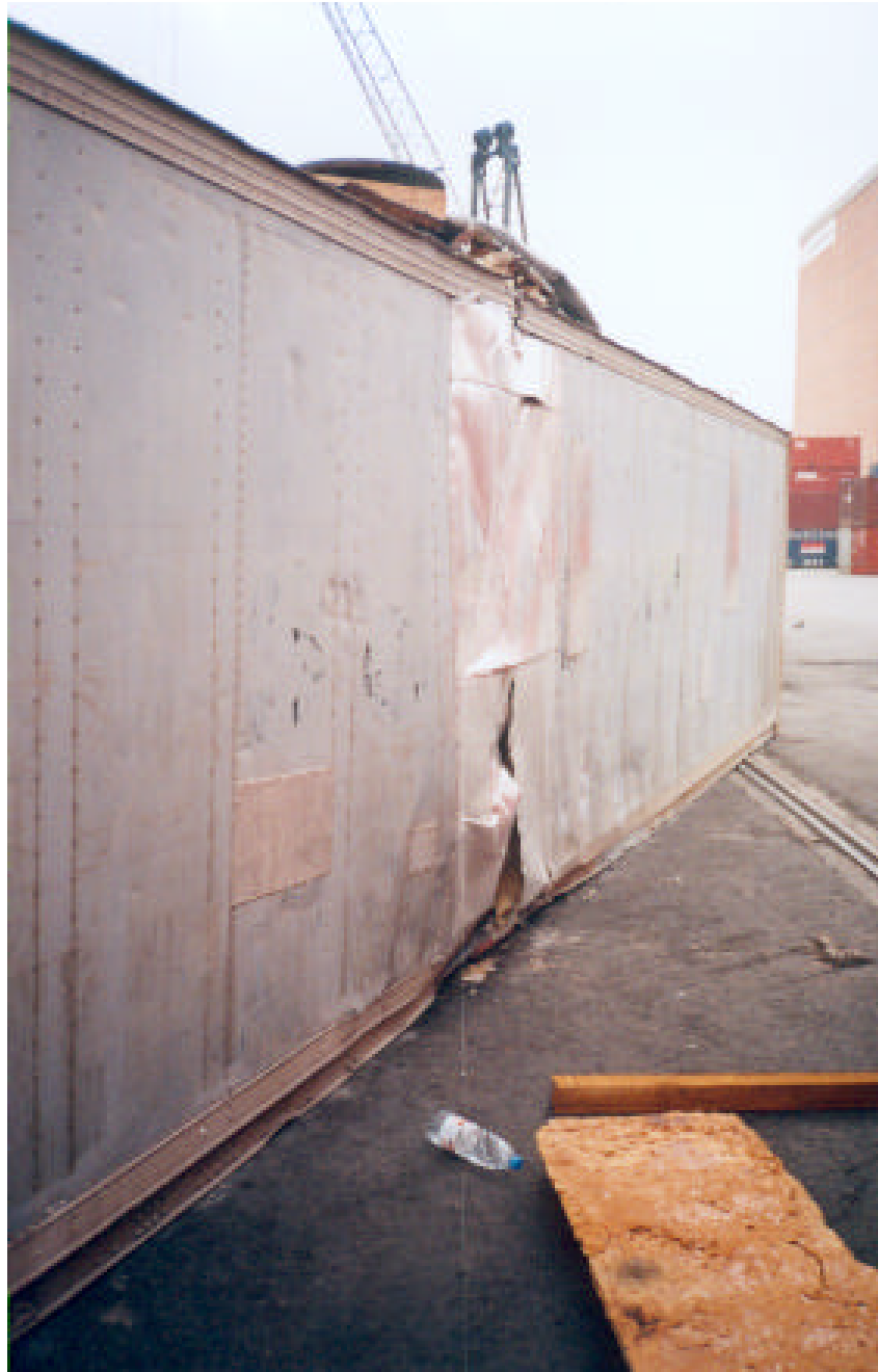
Fotografía nº 27. Contenedor reefer de 40', partido por la mitad al ser manipulado incorrectamente con eslingas y ganchos
