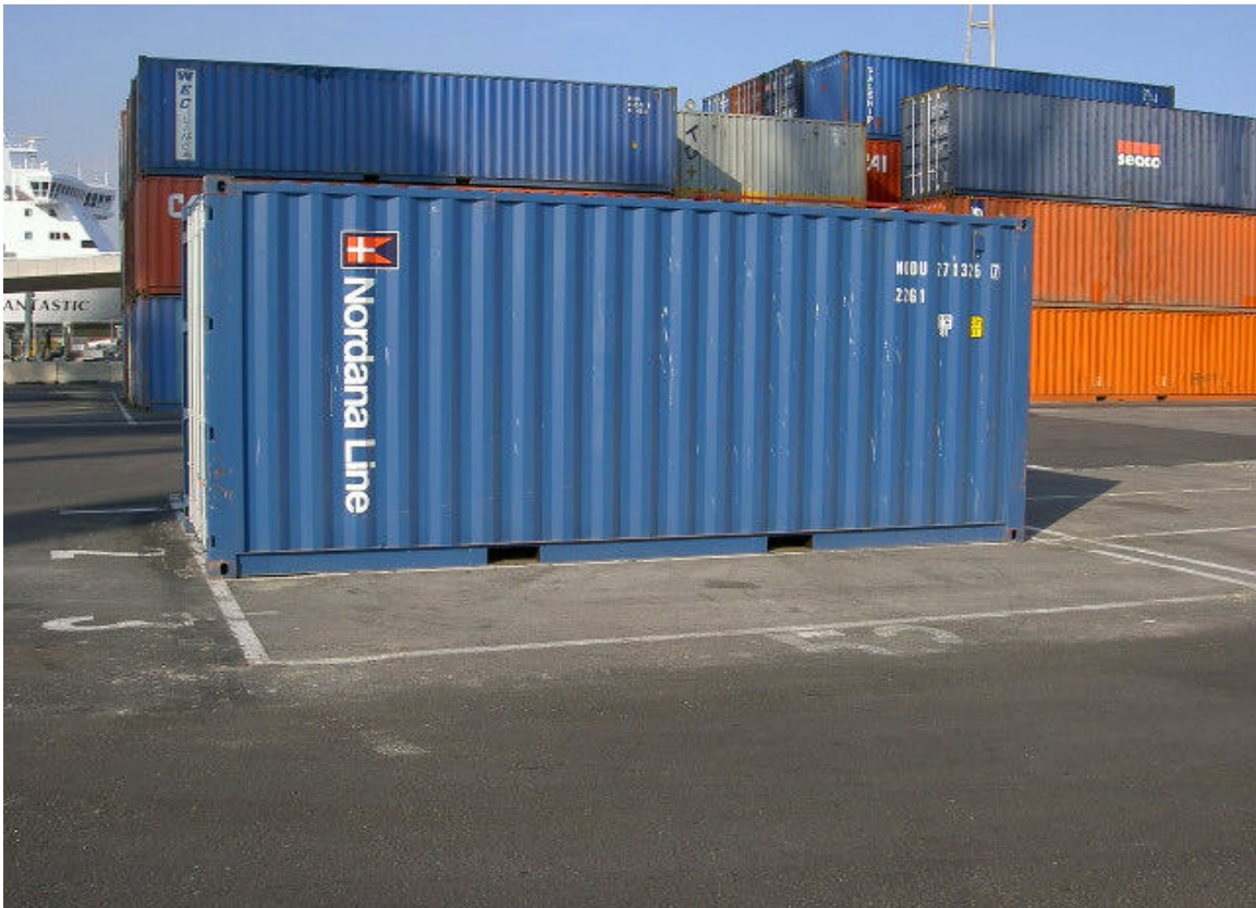
Fotografía nº 3. Contenedor dry container de 20'
