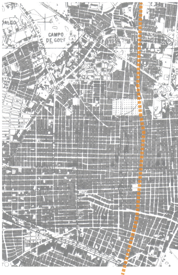
4,34 Transformación de la sección de la calle Moro en el eje Federalismo. La obra consistió en la demolición de media manzana a lo largo de todo el eje y la introducción de la línea 1 del tren ligero.
