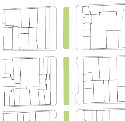
4,34 Transformación de la sección de la calle Moro en el eje Federalismo. La obra consistió en la demolición de media manzana a lo largo de todo el eje y la introducción de la línea 1 del tren ligero.
