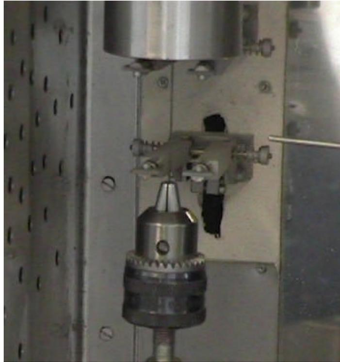
*Figura 4.10. Detalle de la probeta y sistema de anclaje a la máquina.*
