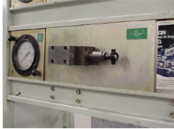
Figura 6.10d – Válvula reductora de presión
