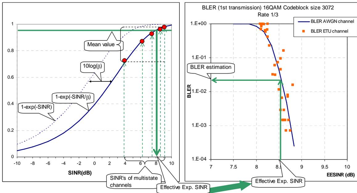
Fig. 10. Example of EESINR and  $\beta$  parameter computation
