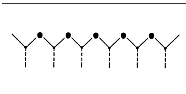
Figura 1.10. Representación esquemática de un polímero tipo peine. Los círculos llenos y los puntos representan los átomos de carbono o los heteroátomos. (Tomado de Daly y col., 1994).
