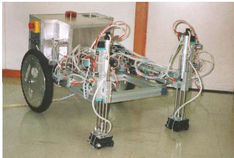
Fig. 1.7. Robot WHEELLEG amb potes i rodes (Guccione i Muscato, 2001)
