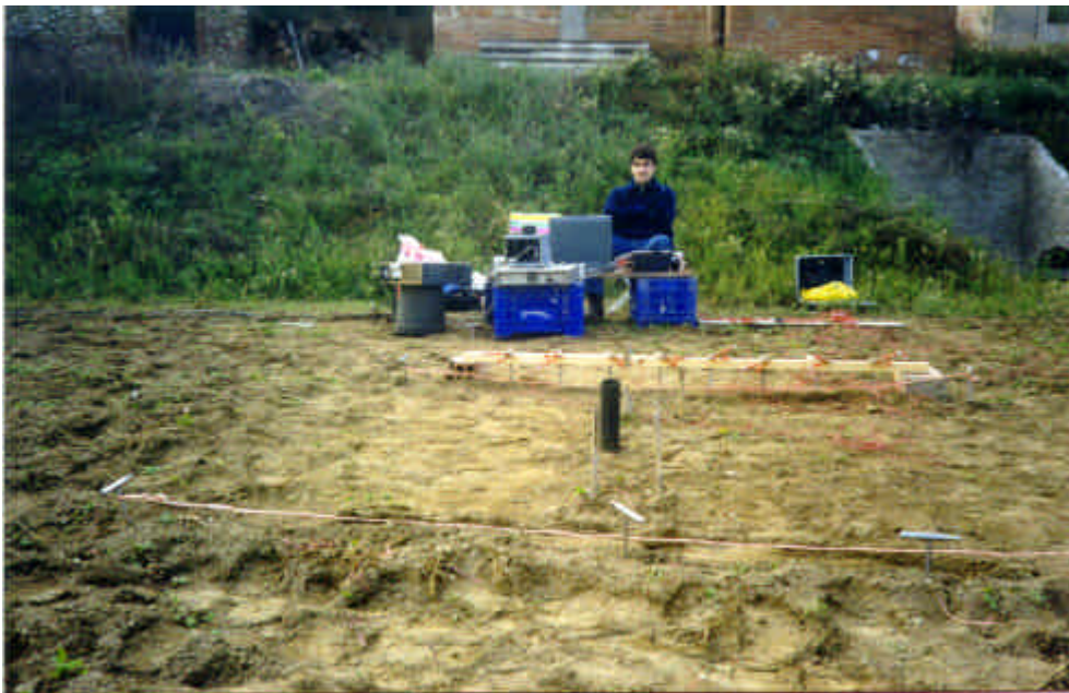
Figura E.8. Imagen de la zona de medida. Los electrodos están montados sobre un soporte de madera para mantener la distancia entre ellos al desplazar la agrupación eléctrica
