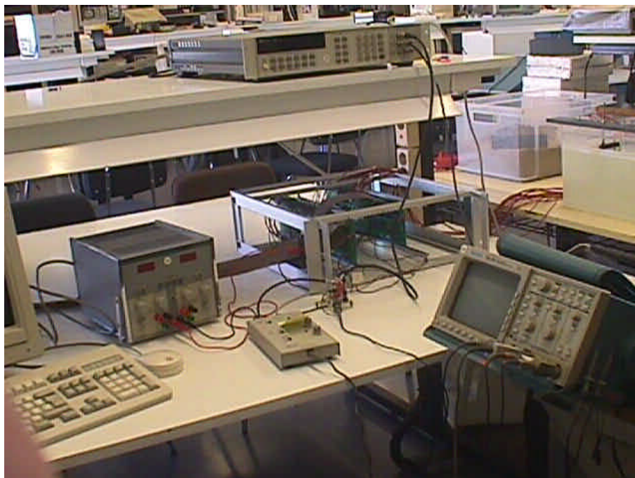
Figura E.1. Sistema PROGEO. En la imagen se aprecia, en la parte superior, el generador de funciones HP3245A, y en la parte inferior (de izquierda a derecha) el PC386, la fuente de alimentación PROMAX, la sonda diferencial ADA400A, el sistema de conmutación (montado en un rack), y el osciloscopio TDS420.
