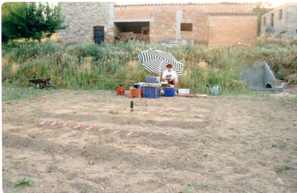
Figura E.6. Imagen de la zona de medida. En la zona central se aprecian dos agrupaciones de electrodos y el tubo de plástico para verter el agua que simulará la fuga.
