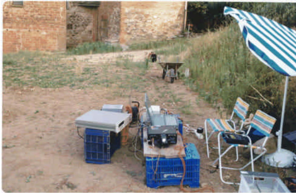
Figura E.5. Sistema de campo. En la imagen se aprecia el módulo Daqbook120 (IOTECH), el PC portátil, el generador de funciones HP3245A, el osciloscopio portátil THS710A (Tektronik) y el detector DIES.
