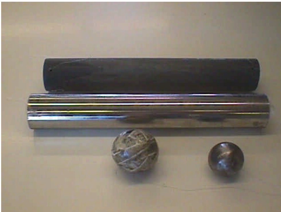
Figura E.4. Objetos utilizados para realizar las medidas. En la imagen se observa un cilindro de PVC, otro conductor, una esfera conductora y otra de goma recubierta de plástico.
