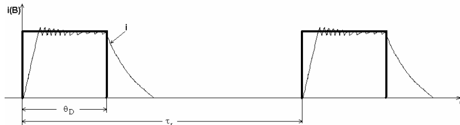
Figura I.5.1.- Forma de onda de la corriente durante el ángulo de conducción \theta_D .
