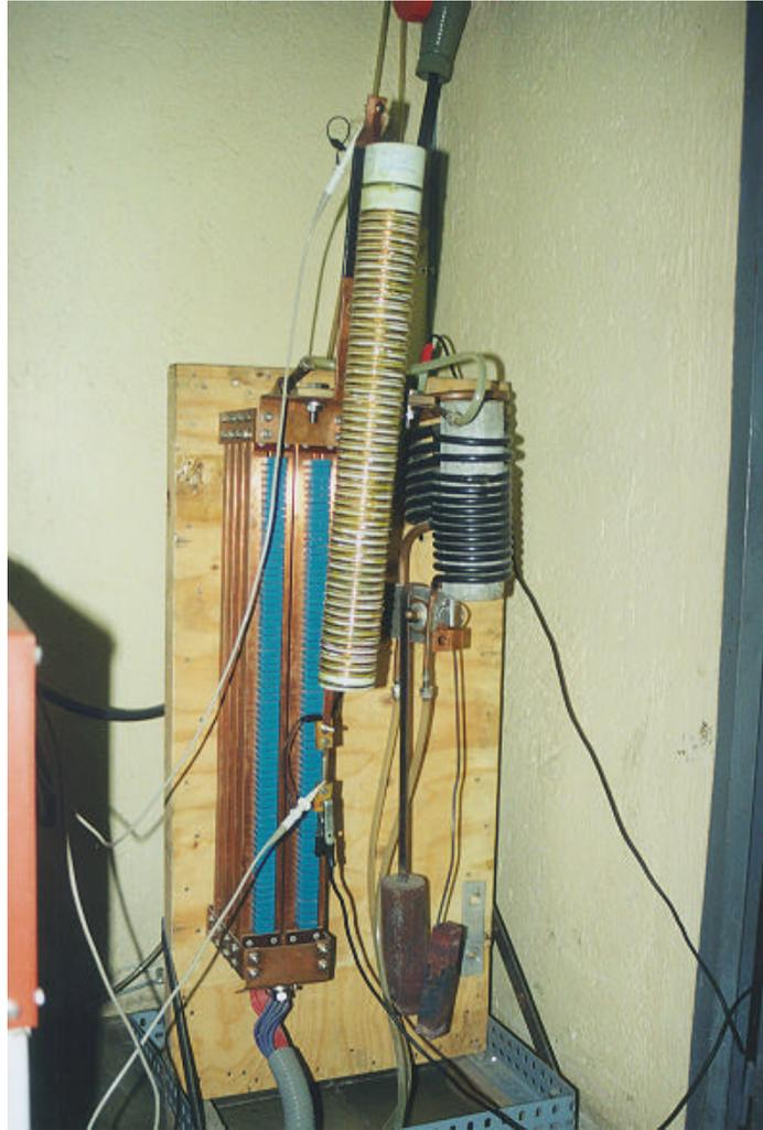
Foto. 18 : Detalle del prototipo M-3, conectado a la fuente de alta frecuencia (5 kHz).
