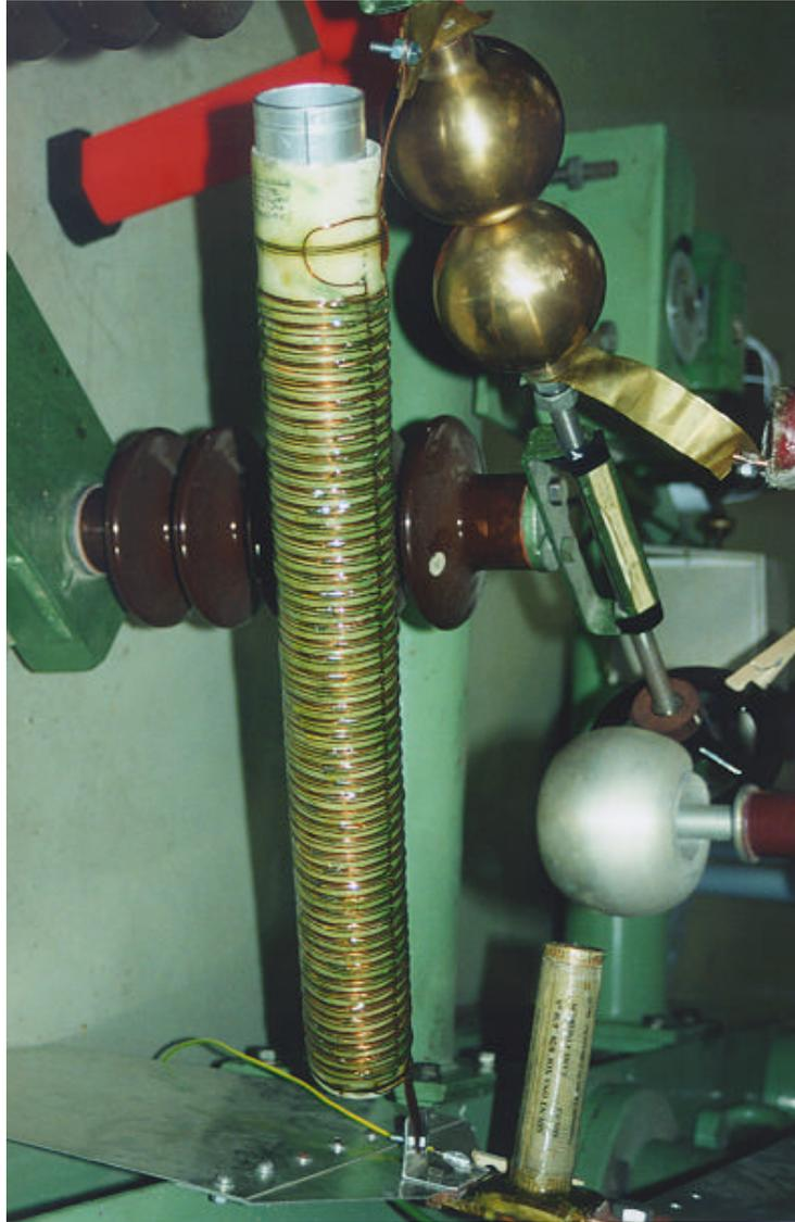
Foto. 20 : Detalle del conexionado del prototipo M-3 a la fuente de Alta Tensión, regulada a 6,9 kV mediante la distancia entre las esferas.
