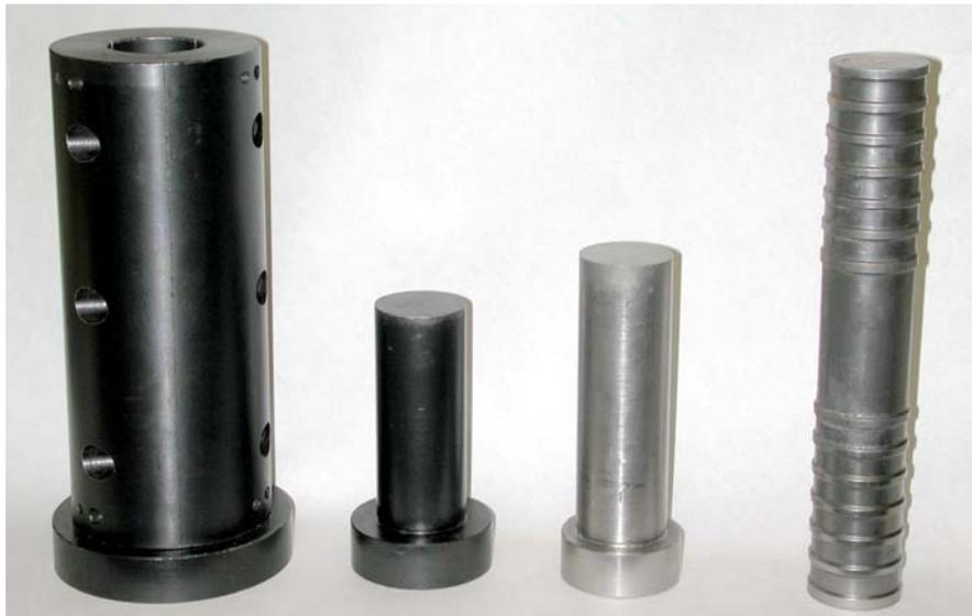
Figura 4.5 Molde y pistones de compactación para elaborar muestras en tres capas.
