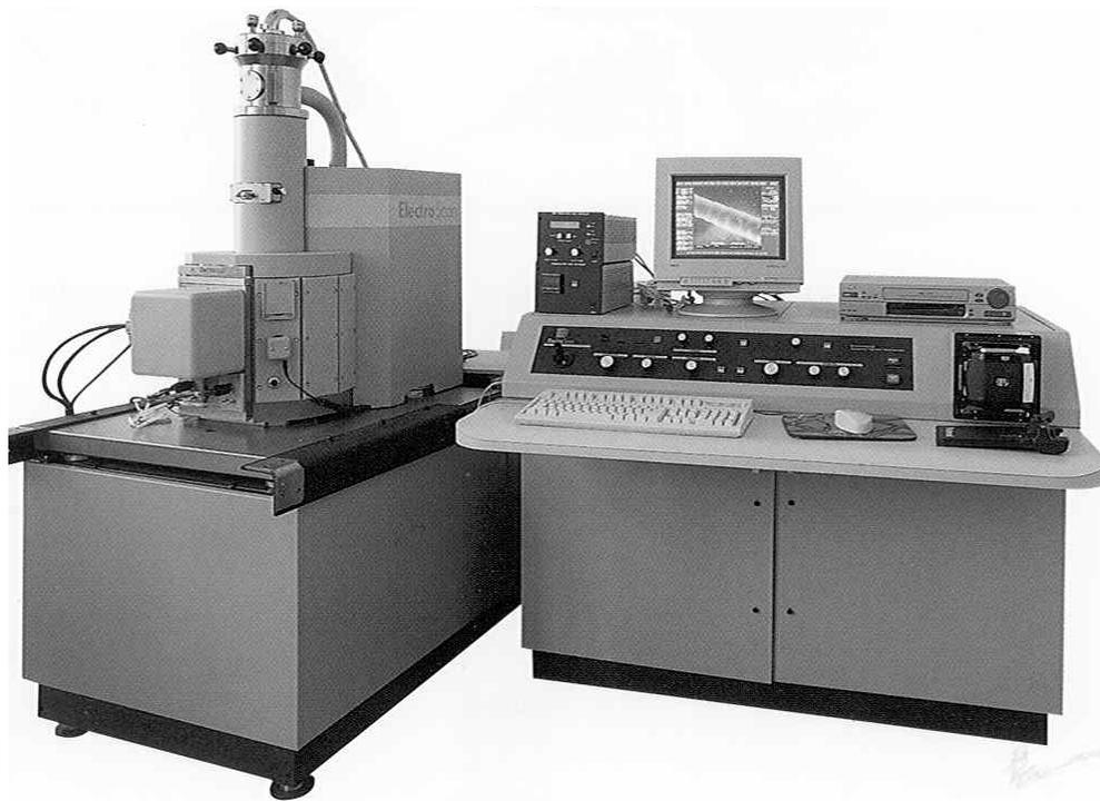
Figura 4.11 Microscopio electrónico de barrido ambiental Electroscan 2020 (ESEM).
