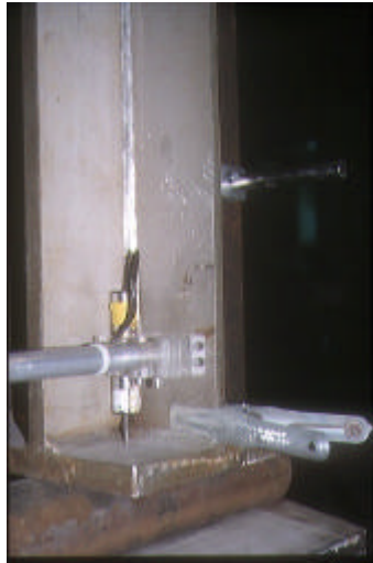
Figura 6-13. Transductor dispuesto para los descensos del apoyo.
