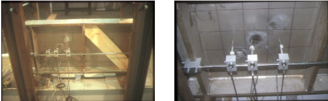
Figura 6-11. Disposición de los transductores en la línea media del panel para medir los desplazamientos en el plano normal al alma.
