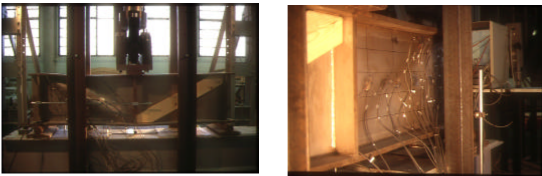
Figura 6-43. Abolladura en la viga ad2w4.
