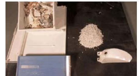
ABS recuperado de neveras en desuso, pellets recuperados por Froth flotation y óptica de luz piloto fabricada con material 100% reciclado
