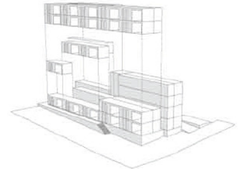
Conjunto de 36 viviendas de venta promovidas por Incasòl (Institut Català del Sòl) en Torelló. Módulos de estructura de acero recuperables. Sistema Modultec [InCaSol 2008].
