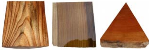
Muestras de madera para ensayos técnicos de durabilidad y abrasión con aplicación de barniz natural. Fuente: Le Tonkinois
