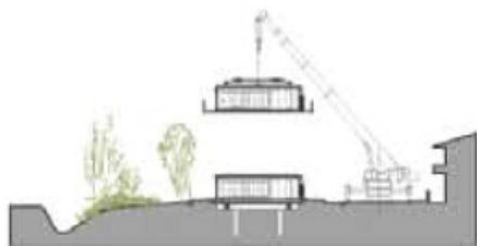
Conjunto de 30 viviendas de alquiler promovidas por IncaSòl (Institut Català del Sòl) en Banyoles. Módulos de hormigón armado recuperables. Sistema Compact Habit [InCaSol 2008].
