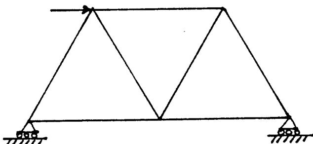
Aquest seria un tipus d'estructura sense solució tant pel programa STRESS com pel programa TEP32, ja que aplicant-li la força que està grafiada el sistema quedaría en moviment continu i sense Estat d'Equilibri.
