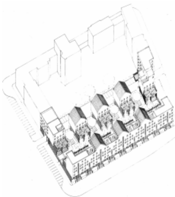
Axonométrica do projeto final. A implantação no terreno permanece a mesma que a prevista anteriormente, tendo sido modificados os materiais de revestimento e as pequenas torres, que passaram a ter fechamento em duas águas e empenas triangulares.
