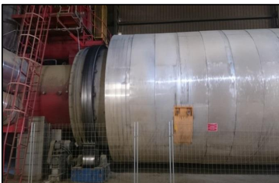
Figura 7. Trommel fet girar per un motor elèctric.
