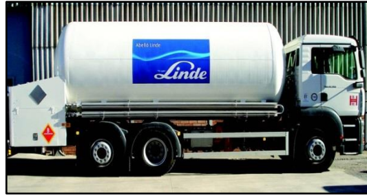
Figura 27. Camió cisterna per transportar GNL.
