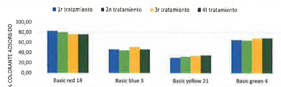
Figura 11: Rendimiento de los cuatro colorantes en los tratamientos sucesivos después de ser recuperado en cada etapa
