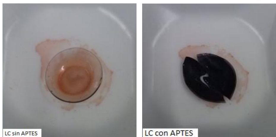
Figura 17. LC tratada con APTES y LC sin tratar después de sumergir en Ninhidrina 2%
