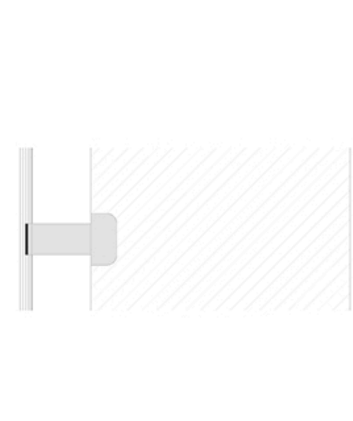
Detall enllaç metàl·lic vidre façana amb el pòrtic interior de vidre laminat E: 1/10
