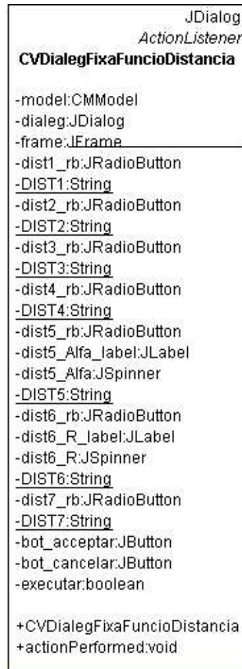
Figura 4.6: Diagrama de classes del diagrama per fixar la funció de càlcul de distàncies, CVDialegFixaFuncioDistancia
