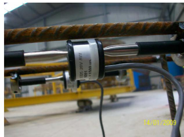
*Figura 11. Col·locació dels extensòmetres de corda vibrant.
