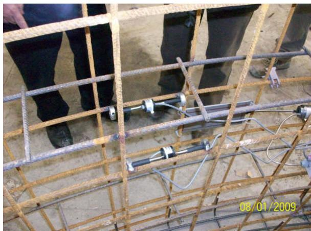
*Figura 4. Ubicació dels extensòmetres de corda vibrant (convencional)*
