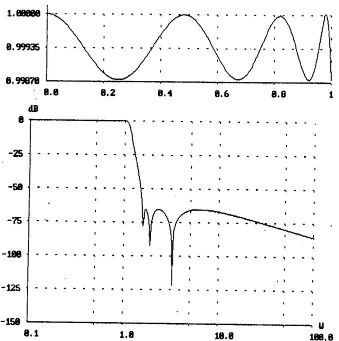
Figura 2b. Filtro elíptico de orden 7. Curvas de respuesta en frecuencia.
