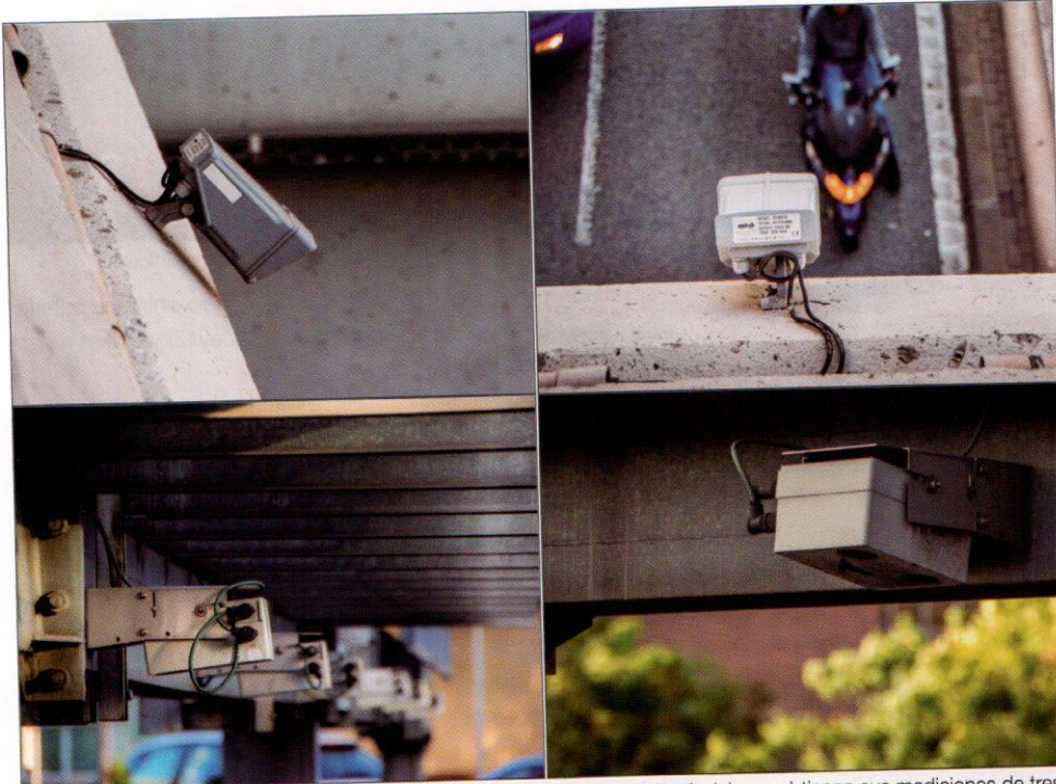
Foto 4. Distintos detectores no intrusivos (llamados detectores DT en el artículo) que obtienen sus mediciones de tres tecnologías redundantes: radar "Doppler", ultrasonidos y detección por infrarrojos pasivos.
