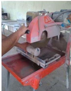
**Figura 7. Procedimiento de corte de especímenes.**
