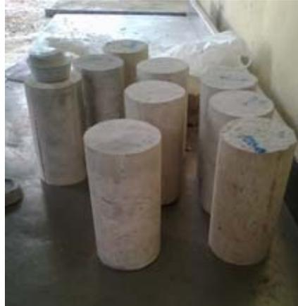
**Figura 2. Especímenes expuestos dentro de la cámara de carbonatación.**
