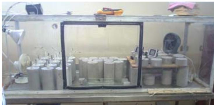
Figura 1. Cámara de carbonatación.
