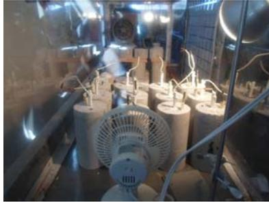
**Figura 4. Colocación de ventiladores dentro de la cámara de carbonatación.**
