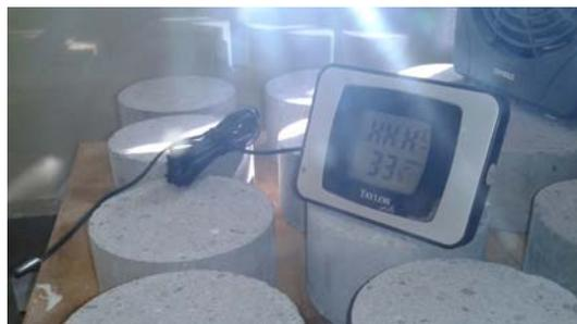
**Figura 6. Termohigrómetro.**
