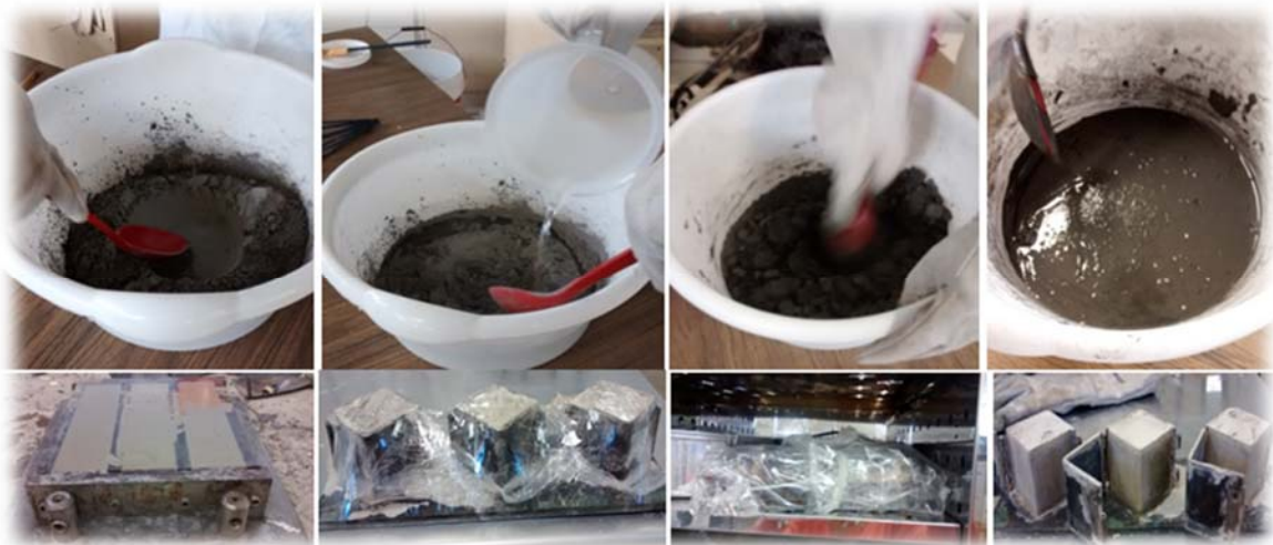
Figura 3 Proceso de fabricación de especímenes.
