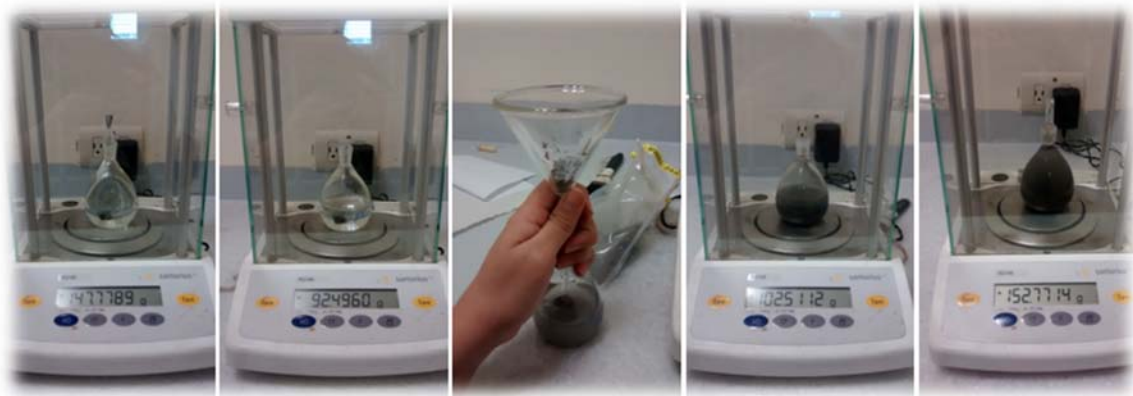
Figura 11 Proceso para determinación de la densidad de las CV
