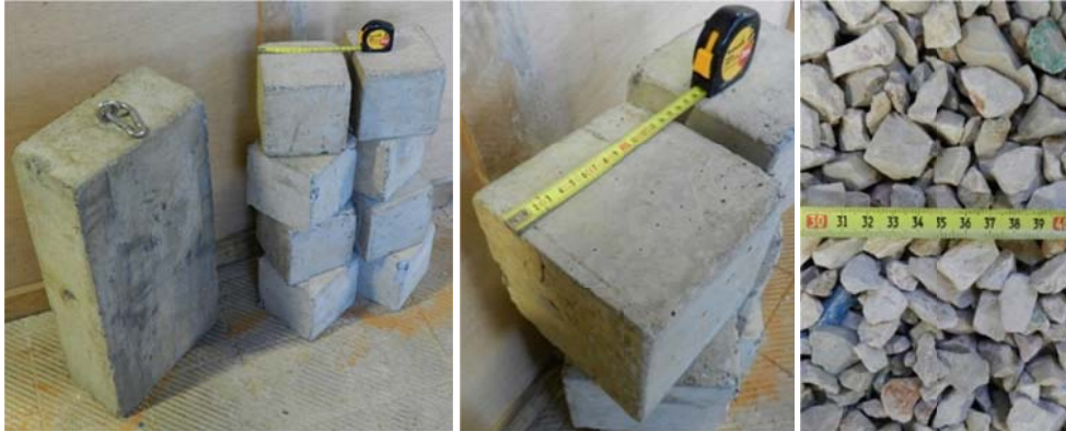
Figura 2. Materiales usados durante la campaña de ensayos en modelo físico. Material no fragmentado y ligeramente fragmentado (izquierda) y material muy fragmentado (derecha).
