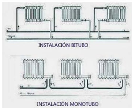
Figura 1. Instalación bitubo y monotubo
