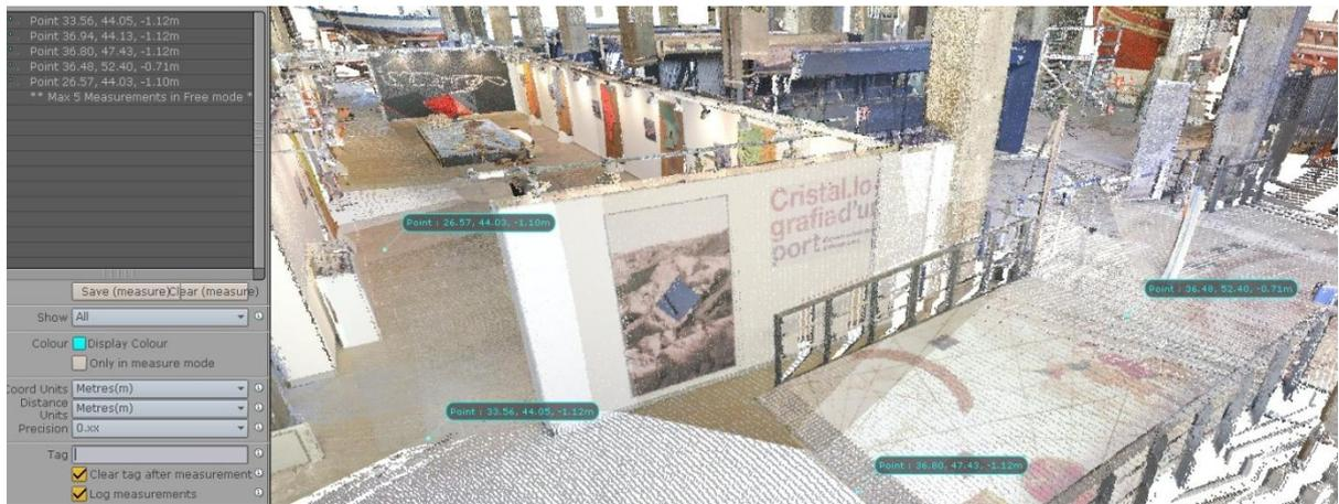
Figura 6: Imagen obtenida a partir de la nube de puntos coloreada del TLS.
