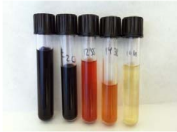
FIGURA 1: Decoloración de efluentes industriales con la celda UVEC.
