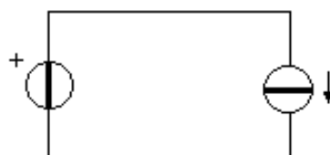
Figura 8. Convertidor tensió-corrent amb únic sentit d'enllaç.
