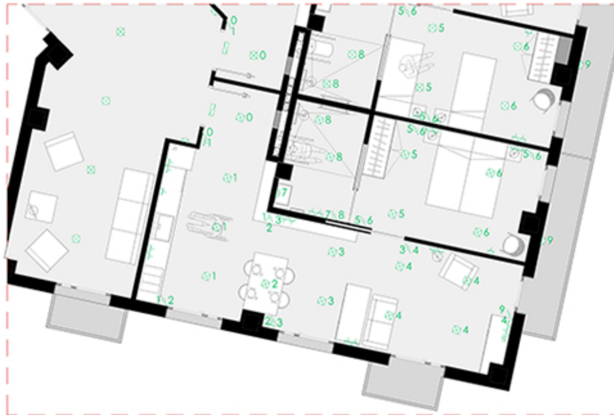
PLANTA TIPUS: Instal·lació elèctrica Unitat 2
