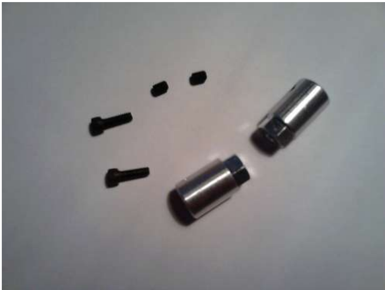
Fig 32 : Casquets i cargols per fixar-los i per fixar les rodes
