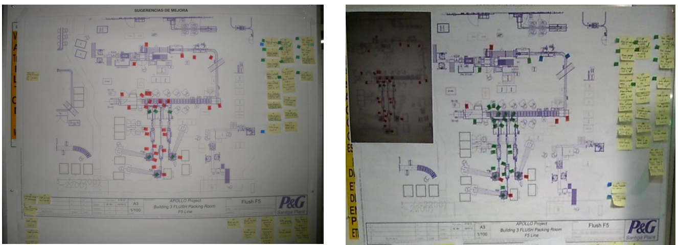
Fig.15. Comparación del “Layout” de la Línea pre intervención (izquierda) vs post intervención (derecha)
