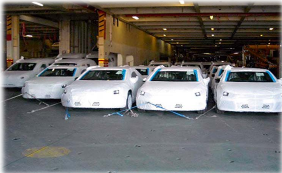
Figura 34: Coches trincados en la cubierta de un buque
