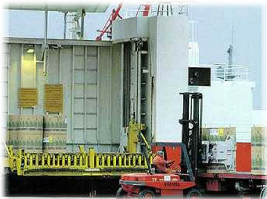
Figura 12: Sistema de carga roto-loader en operativa
