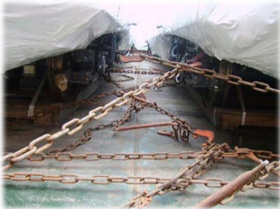
Figura 28: Carga trincada con Cadenas
