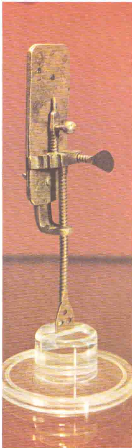
Figura 8. Microscopio de 125 aumentos, construido y utilizado por Leeuwenhoek, entre 1672 y 1723.
