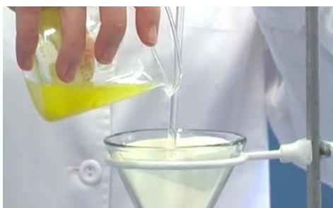
Figura 3. Filmación de la filtración a presión atmosférica.
