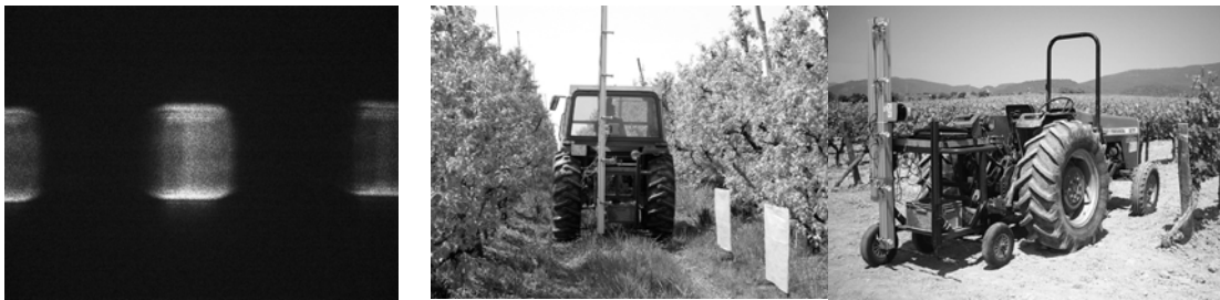
Figura 1. A) Imagen del impacto del rayo láser. B) Equipo para la toma de datos en campo: frutales (izquierda) y viña (derecha)
