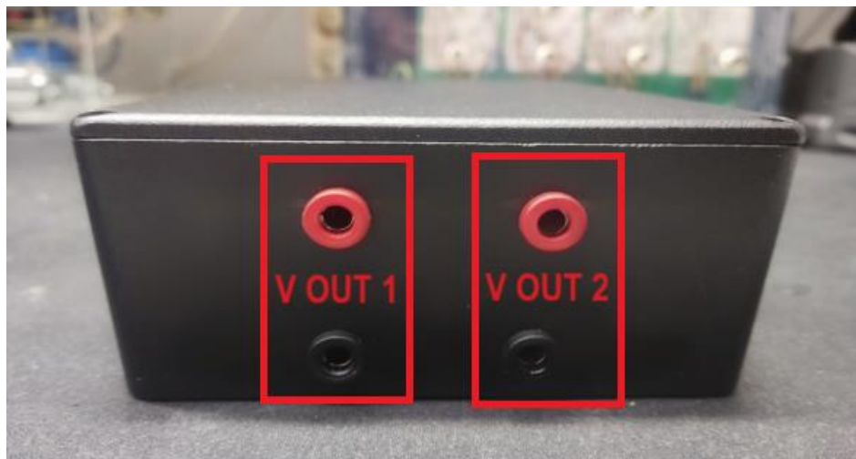
Figura 5. Vista trasera de la caja de control y potencia.
