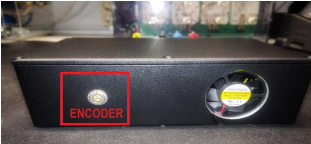
Figura 4. Vista lateral izquierda de la caja de control y potencia.
