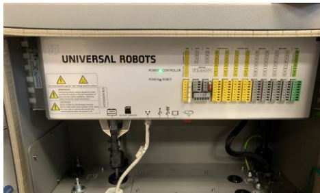
Ilustración 5. Interior controlador robot UR3e y los puertos de conexión. Fuente: Universal Robots Academy.
