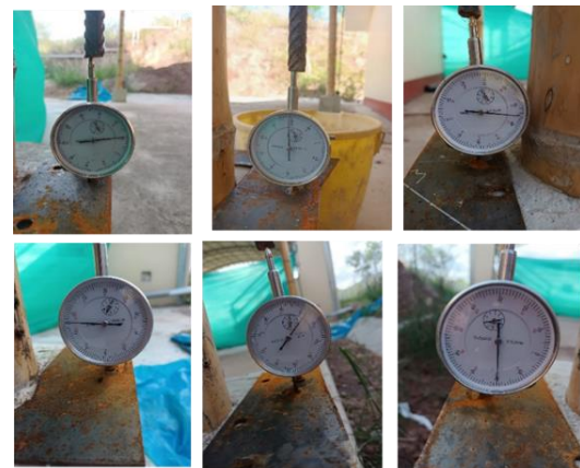
Figura 9. Medición de los 06 comparadores en las columnas de bambú del prototipo de vivienda.
