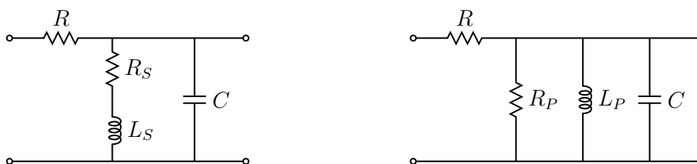
(a) Filtre passabanda R-LC amb bobina no ideal. (b) Circuit anterior amb el model paral·lel.
