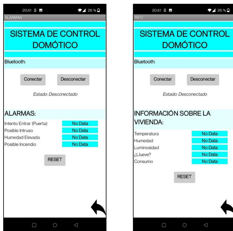
Figura 94: Pantalla "Alarmas" (imagen de la izquierda) y pantalla "Información" (imagen de la derecha) de la aplicación móvil. (Fuente: elaboración propia)
