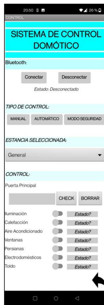
Figura 93: Pantalla “Control” de la aplicación móvil. (Fuente: elaboración propia)
