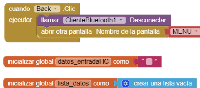
Figura 18: Programación de la pantalla “INFORMACIÓN” de la aplicación móvil, parte 2. [Fuente propia]
