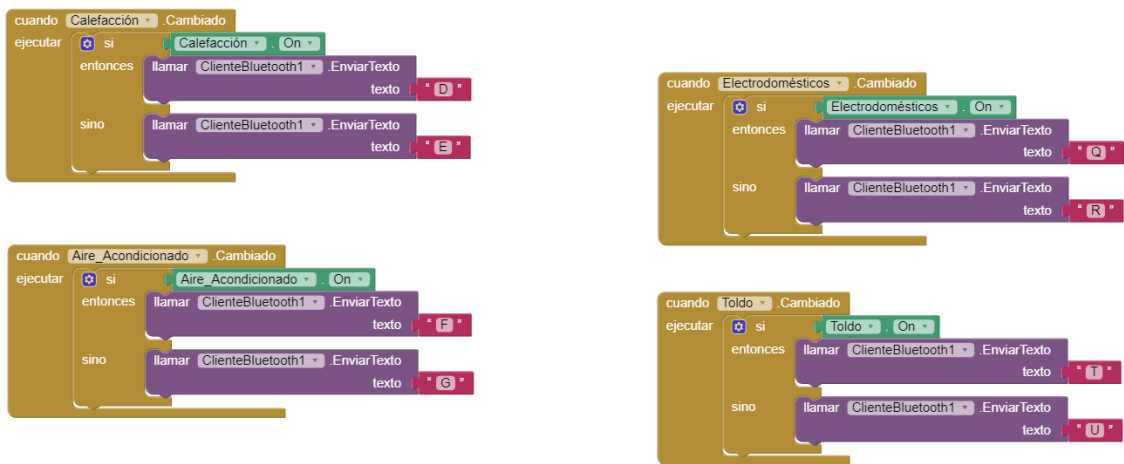
Figura 10: Programación de la pantalla "CONTROL" de la aplicación móvil, parte 6. [Fuente propia]
