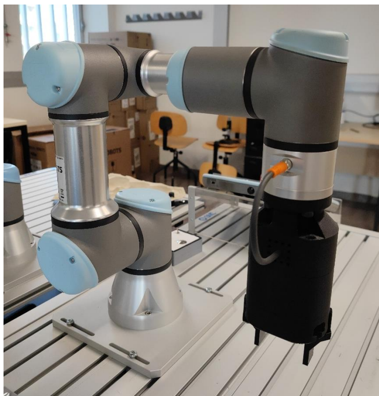
Figura 3.2. Robot UR3e del laboratori amb la pinça instal·lada (Font: Autor)
