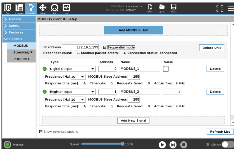
Figura 3.3. Configuració de MODBUS dins de PolyScope (Font: UR)
