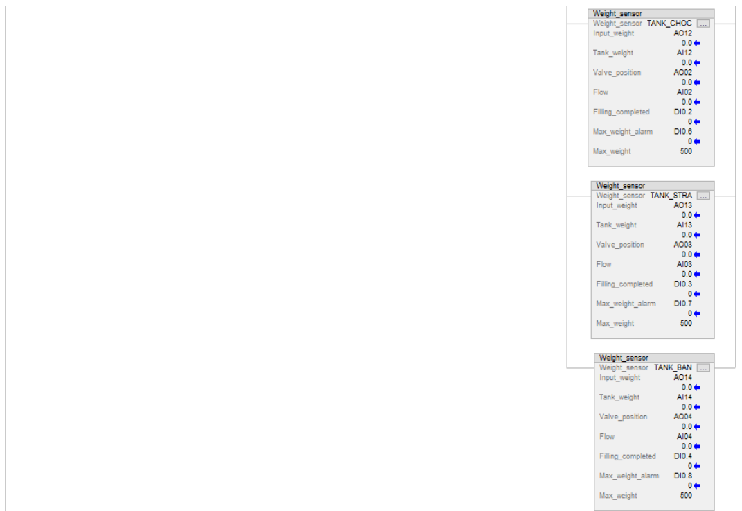
Figura 3.19. Disseny de la subrutina _10_ Weight_sensors (3/3).
