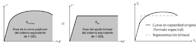
Fig. 21: Representación bilineal del espectro de capacidad.
