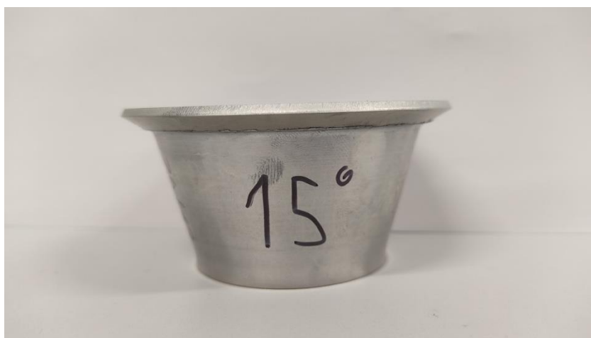
Figura 4.38: Pieza de AA7075 laminada con un ángulo de 15°
