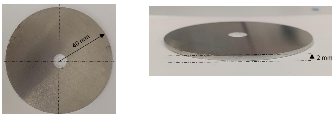
Figura 4.15: Diseño del disco utilizado para la laminación cónica
