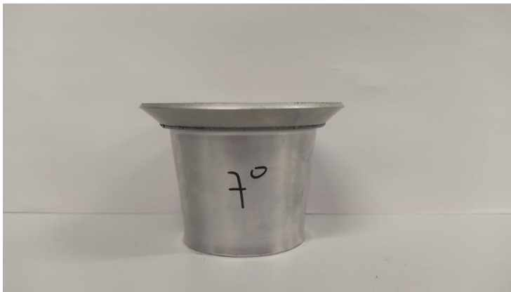
Figura 4.35: Pieza de Al 6082 laminada con un ángulo de 7^\circ
