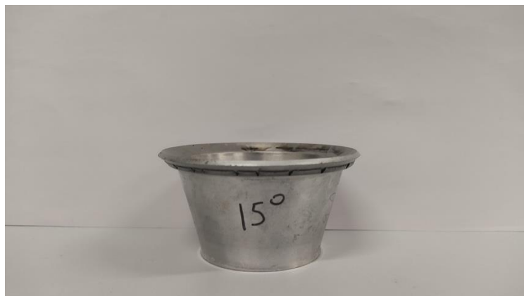
Figura 4.31: Pieza de Al 6082 laminada con un ángulo de 15^\circ
