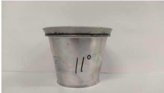
Figura 4.33: Pieza de Al 6082 laminada con un ángulo de 11^\circ
