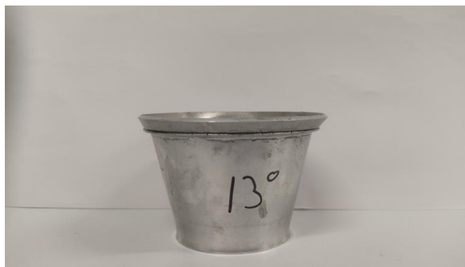
Figura 4.32: Pieza de Al 6082 laminada con un ángulo de 13^\circ
