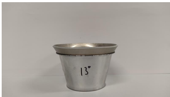
Figura 4.39: Pieza de AA7075 laminada con un ángulo de 13°
