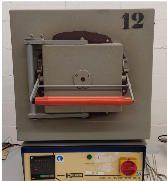
Figura 4.22: Horno PXR4/5/9 utilizado para la aplicación de los tratamientos térmicos
