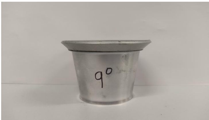
Figura 4.34: Pieza de Al 6082 laminada con un ángulo de 9^\circ
