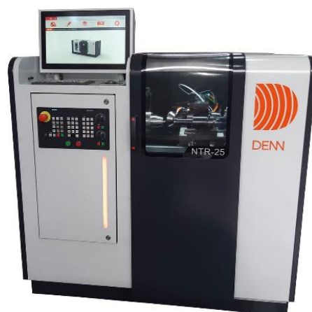
Figura 4.19: Máquina de laminación cónica NTR-25 DENN [12]
