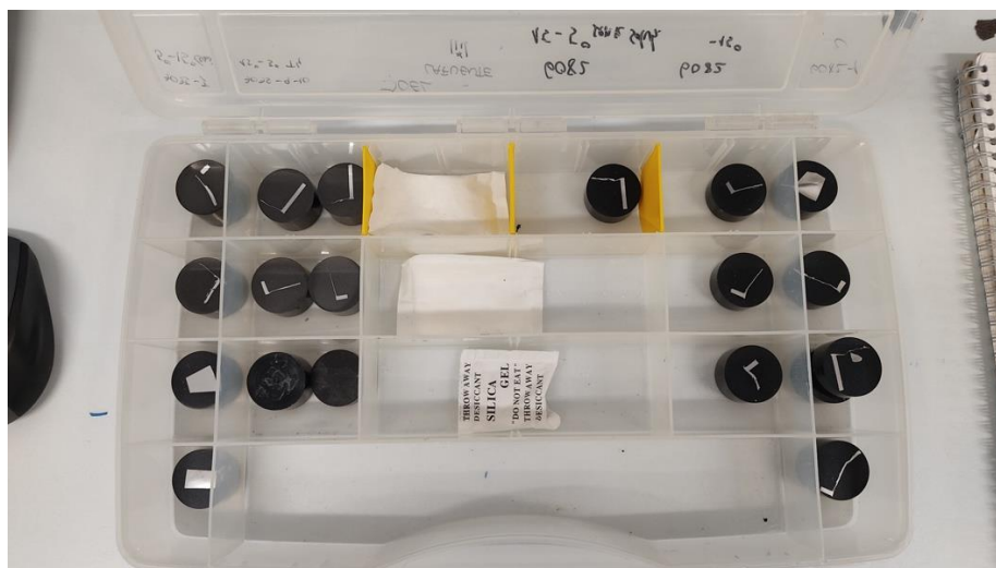
Figura 4.16: Caja de muestras para análisis mediante ensayos de microdureza
