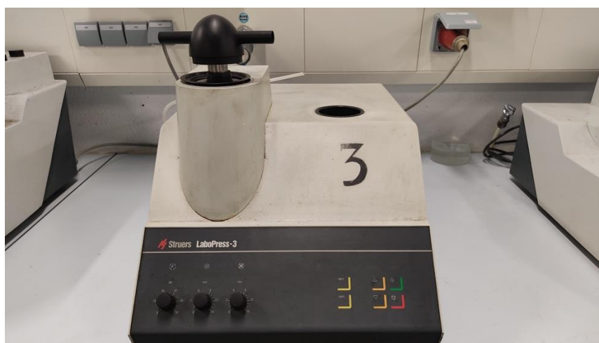
Figura 4.17: Máquina Struers LaboPress-3
