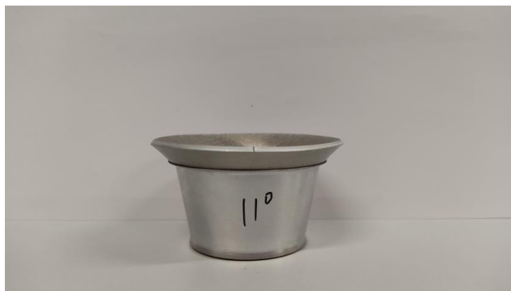
Figura 4.40: Pieza de AA7075 laminada con un ángulo de 11°
