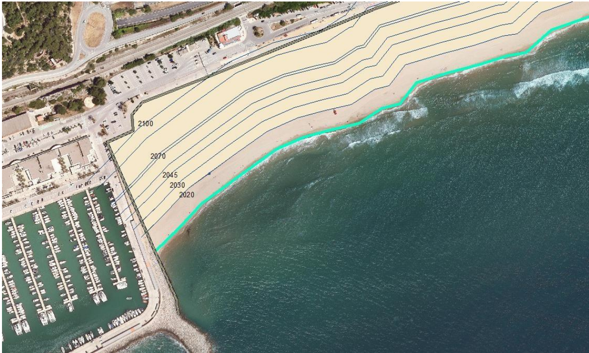
Figura 4.10: Polígons creats amb les capes; línia rígida i línies de retrocés. Captura de pantalla d'ArcGIS.
